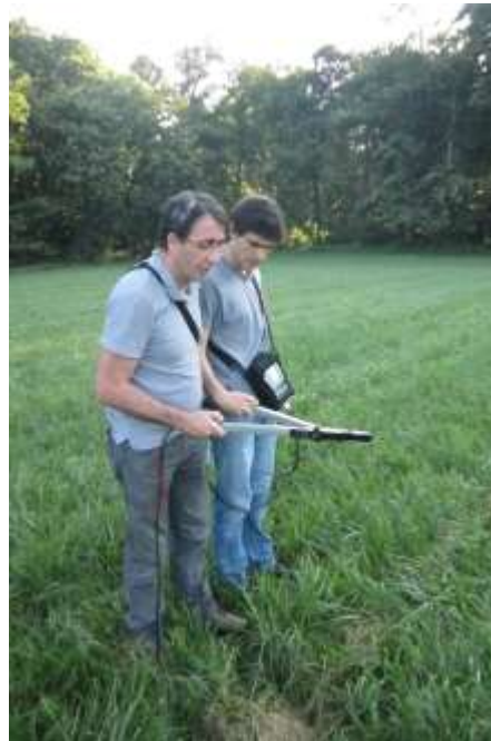
Opérateurs de l'IDF en cours d'inter-calibration d'analyseurs de couverts LAI-2000 (Li-Cor) en plein découvert (zone de référence)
