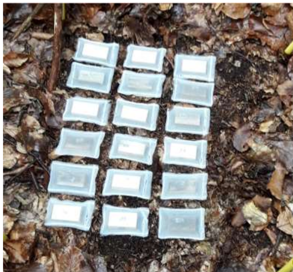
Dispositif d'incubation in situ de bûchettes de hêtre à différents stades de pré-dégradation causée in vitro par Gloeophyllum trabeum .
